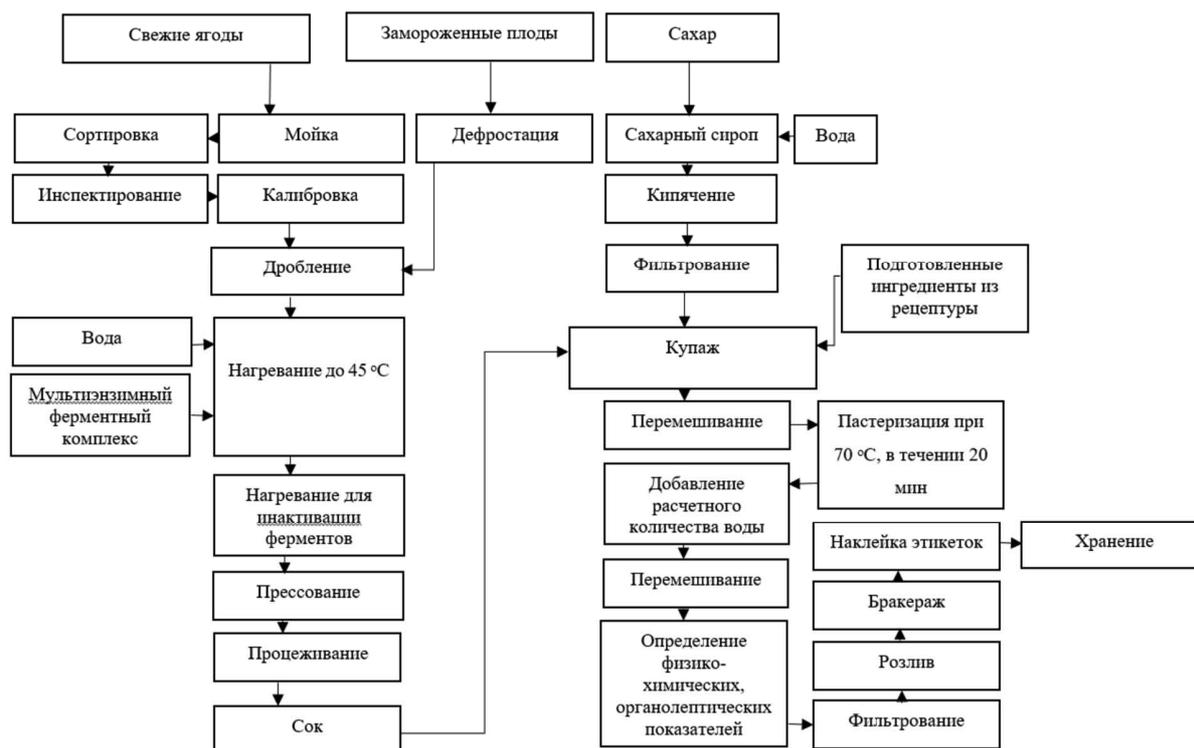
Рисунок 1 Принципиальная схем производства напитков на основе костяники каменистой с применением полиферментного комплекса
