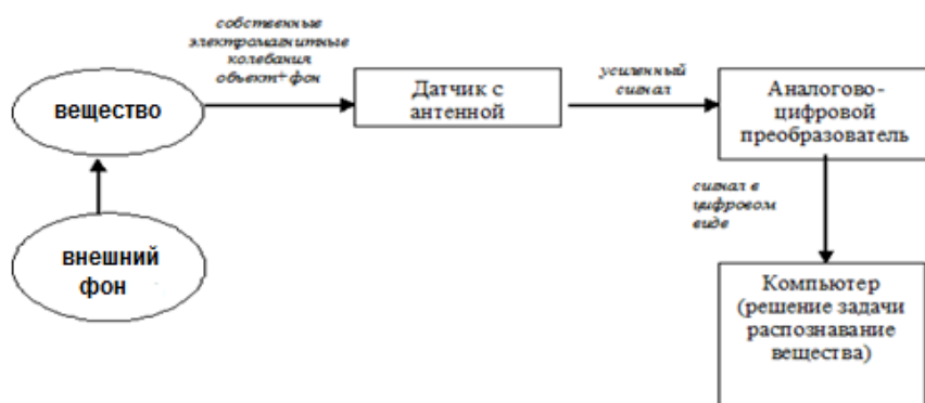
Рис. 2. Структурная схема системы распознавания веществ.
