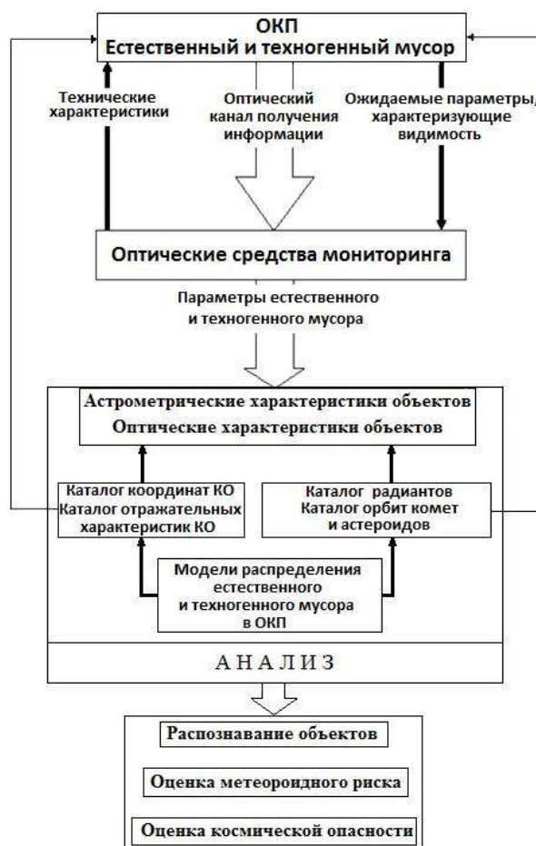
Рис. 1. Схема организации системы мониторинга объектов в ОКП оптическими средствами
