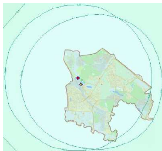
Рис.3 Распространение \text{HNO}_3 над территорией города при неблагоприятных погодных условиях (скорость ветра = 0,5 м/с, осадков - нет).
