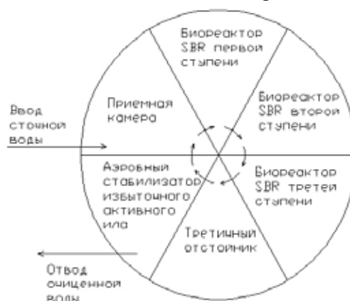
Рисунок 1 – Технологическая схема очистки сточных вод на индивидуальном очистном сооружении.
