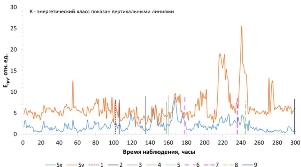
Рис. 2. Энергетические характеристики на НС РАН. Вертикальными линиями отмечены времена в очаге землетрясений (1-7), зарегистрированных сетью KNET
