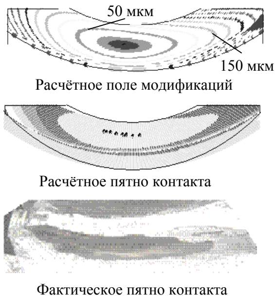
Рис. 2 Локализация контакта в передаче
