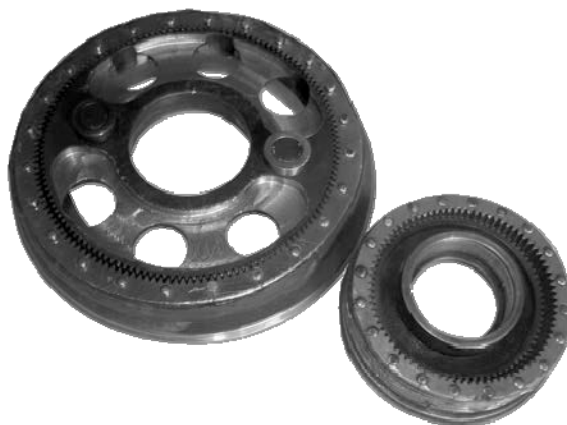
Рисунок 9. Фотография мелко модульных разрезных зубчатых цепей в сборке с сателлитами с числами зубьев цепей 142 и 82 и модулем 1 мм
