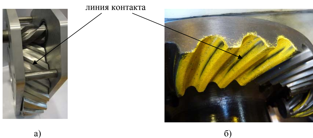
Рис. 5. Линии контакта в ЭЦ-зацеплении: а) в цилиндрическом; б) в коническом.
