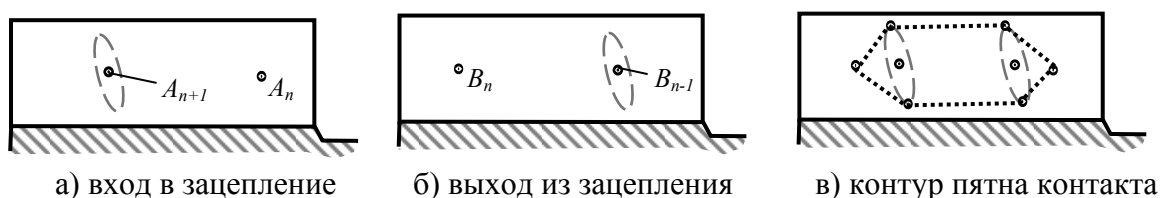
Рис. 1. Пятно контакта на развёртке зуба при синтезе одно-двух-парного нагруженного контакта
