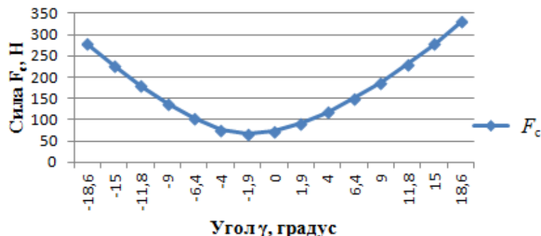
Рис.7. Зависимость силы F_c на третьем теле качения от угла \gamma
