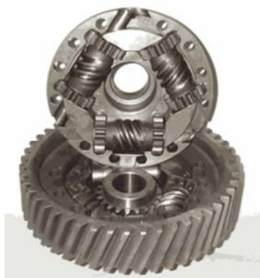
Рис. 3. Дифференциал для заднего моста автомобиля «Урал»
