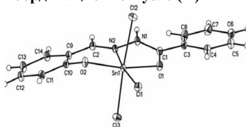
Рис.1. Структура и длины связей (Å) в координационном узле (II)
