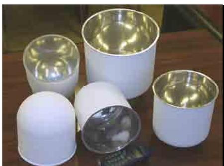
Тигли из композита Pt-Al<sub>2</sub>O<sub>3</sub>
