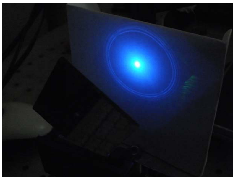
Рис. 2. Результат фокусировки амплитудного фокусатора в кольцо. Для удобства наблюдения изображение показано на расстоянии, превышающее фокусное
