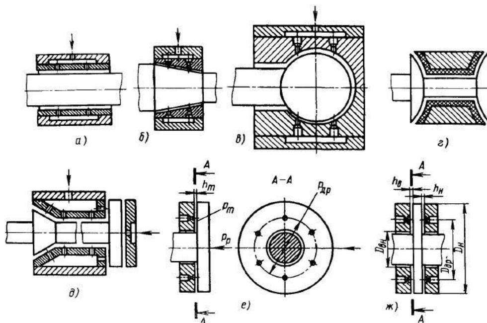
Рисунок 1 – Газостатические подшипники ШУ пассивного типа: а – цилиндрический; б – конический; в – сферический; г – полусферический двусторонний; д – комбинированный; е, ж – упорный.
