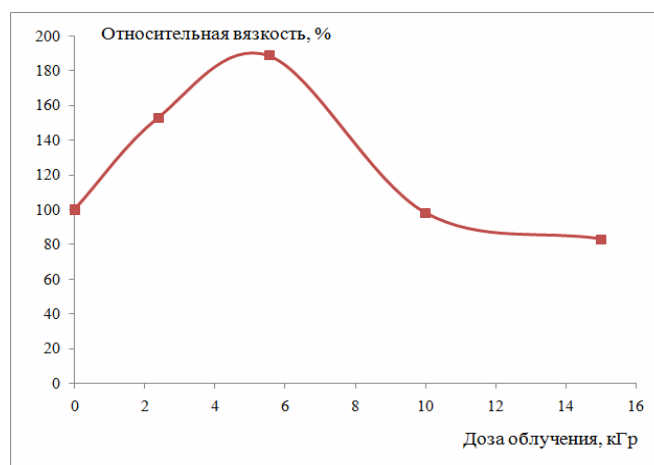
Рисунок 3 – Относительная вязкость системы 6% альгинат + 4% полиэтиленгликоль (40000)+ 6% глицерин в зависимости от поглощенной дозы
