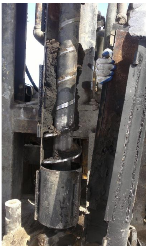
Рис.2. Стендовые испытания. Работа макета бурового снаряда
