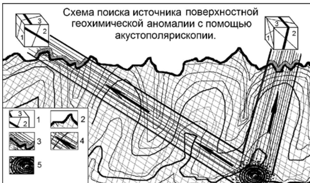
Рис. 3. Схема поисковых акустополярископических работ: 1 – кубический образец с выявленным положением главной плоскости упругой симметрии (жирная линия), 2 – рельеф земной поверхности, 3 – выявленные геохимические аномалии (зоны разгрузки флюида), 4 – пути миграции флюида, 5 – источник флюида. Сетка из тонких пересекающихся линий – система микротрещин.
