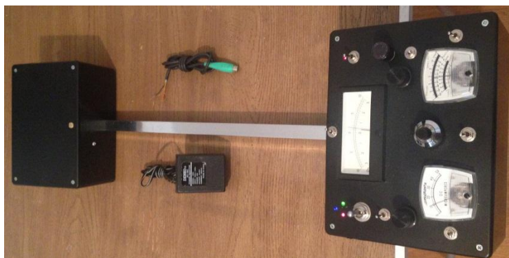
Рис. 2. Прибор SEVA-Integral-M-3 - измеритель ЭМПГ. Светонепроницаемый датчик прибора содержит также CdSe фоторезистор для изучения влияния света на формирование полевых гироскопов.
