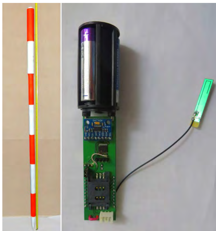
Рисунок 1. Лавинно-обвальный извещатель. Слева - в штатной установке, справа - OEM модуль.
