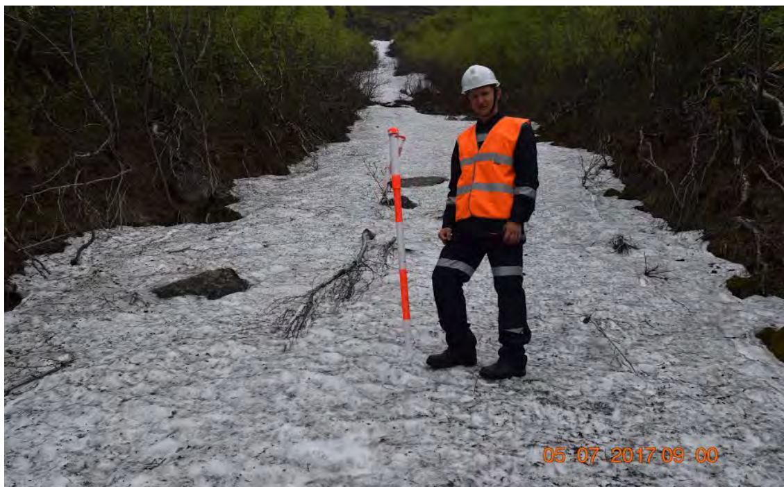
Рисунок 2. Лавинно-обвальный извещатель в месте установки.
