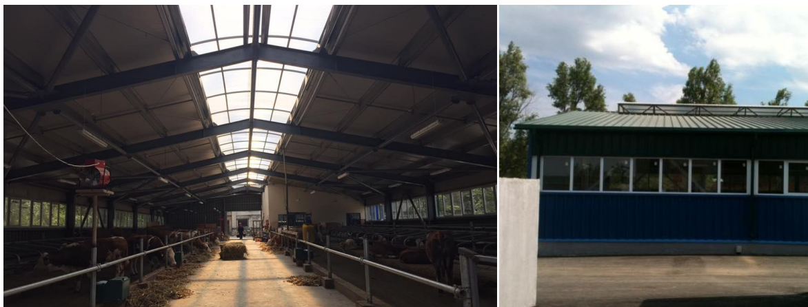
Рисунок 4. – Свето-вентиляционный конек (вид изнутри и сбоку)
