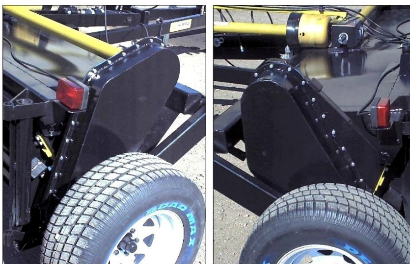
Рисунок 3. – Узел вальцового рекондиционера
