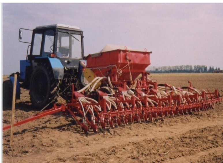
Рисунок 6. – Сеялка пневматическая зернотуковая С-6Т производства ОАО «Брестский электромеханический завод»
