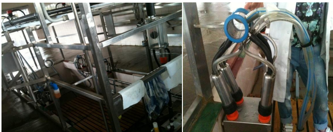
Рисунок 5. – Доильный зал с доильной установкой «Елочка»
