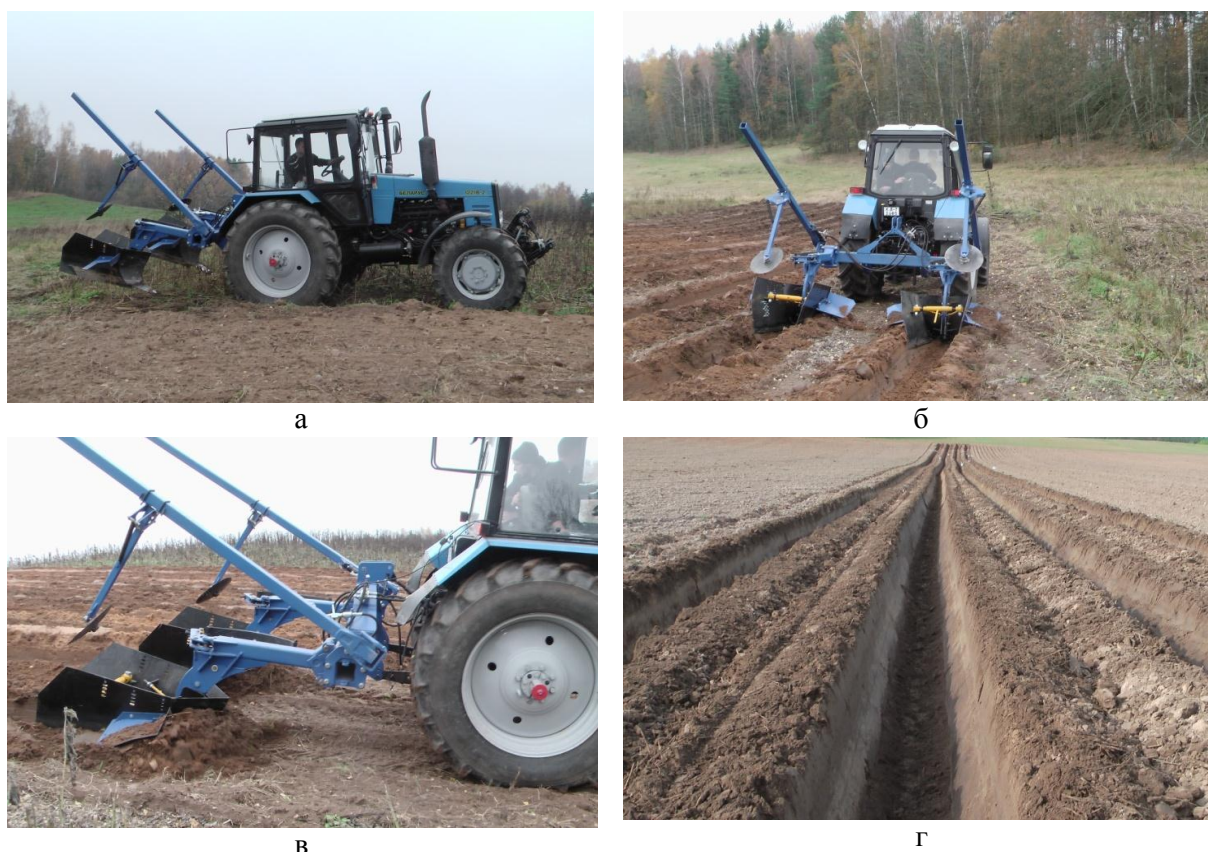
а – транспортное положение; б – рабочее положение (вид сзади); в – рабочее положение (вид сбоку); г – гряды, сформированные грядоделателем
