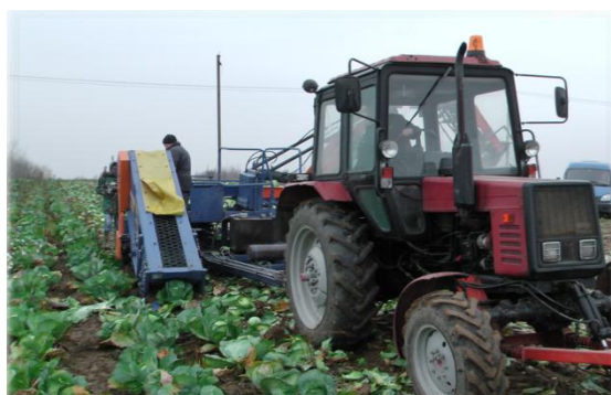
Рисунок 1. – Комбайн для уборки капусты КПК-1
