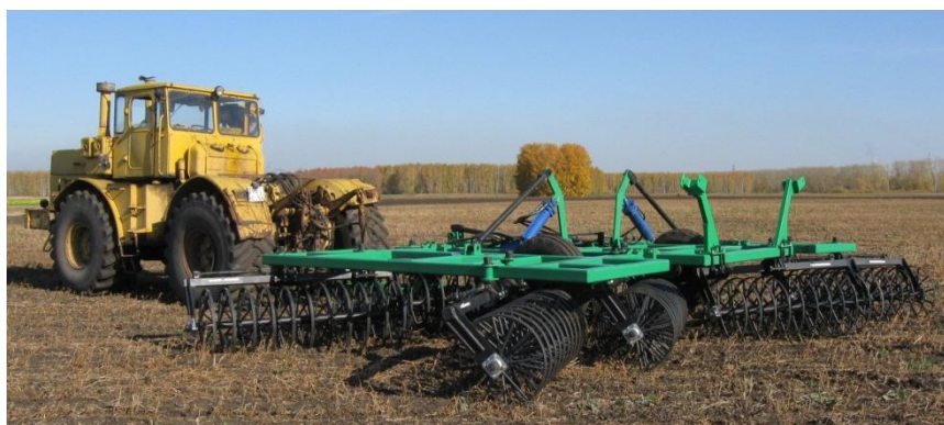
Рисунок 3. – Борона кольцевая секционная «Лидер-БКС-8»
