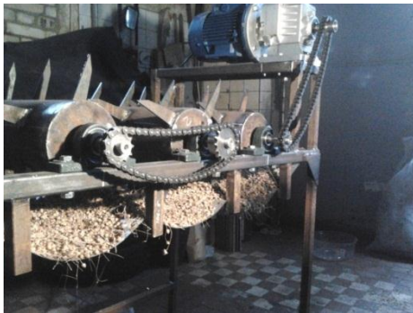
Рисунок 2. – Работа установки с игольчатыми катками
