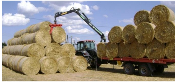
Рисунок 4. – Платформа с манипулятором ПМК-10
