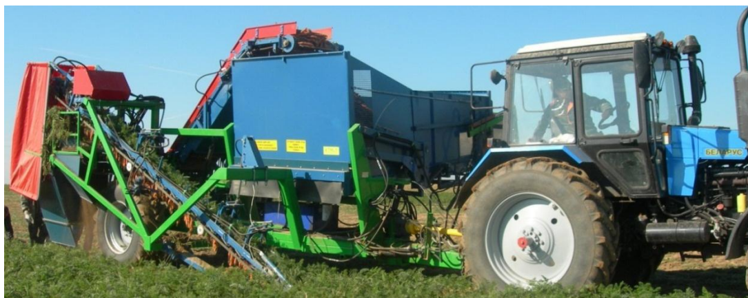
Рисунок 2. – Комбайн теребильного типа для уборки моркови КТМ-1
