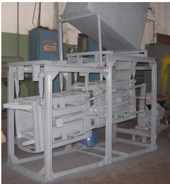
Рисунок 1. – Экспериментальная установка для исследования механизмов очистки решетных поверхностей
