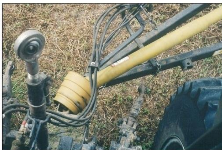
Рисунок 6. – Узел вальцового рекондиционера
