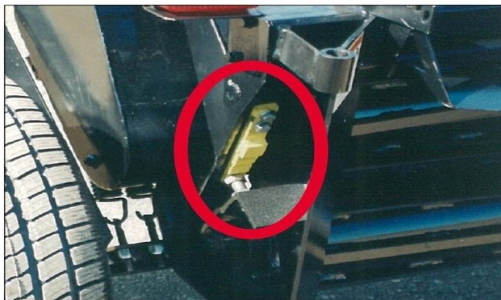
Рисунок 4. – Регулятор зазора между барабанами
