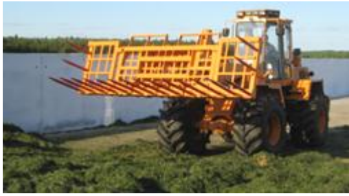
Рисунок 3. – Агрегат для закладки и выгрузки кормов АЗВК
