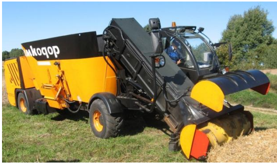
Рисунок 5. – Агрегат самоходный для приготовления и раздачи кормов ССР-12
