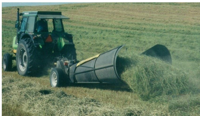
Рисунок 1. – Машина для подбора и плющения стеблей скошенных трав Recon 300
