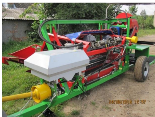
Рисунок 2. – Вид сбоку комбайна полурядного ягодоуборочного КПЯ
