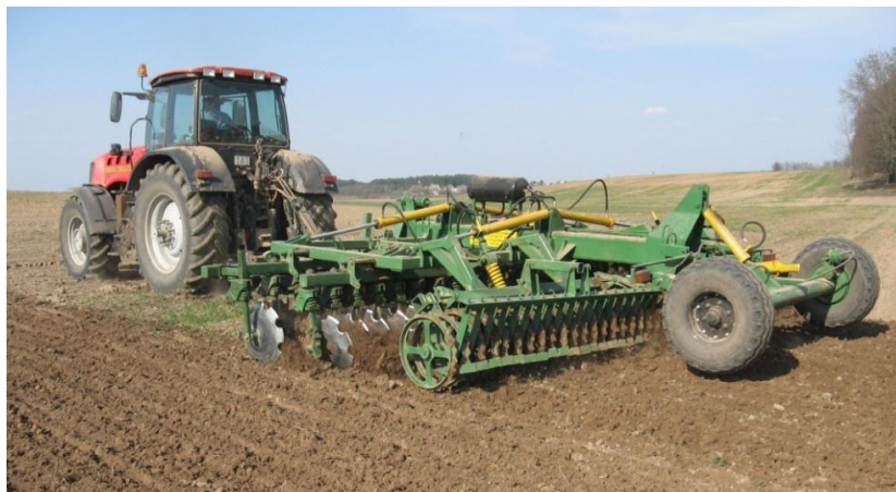
Рисунок 7. – Агрегат почвообрабатывающий дисковый АПД-6 производства ОАО «Бобруйсксельмаш»
