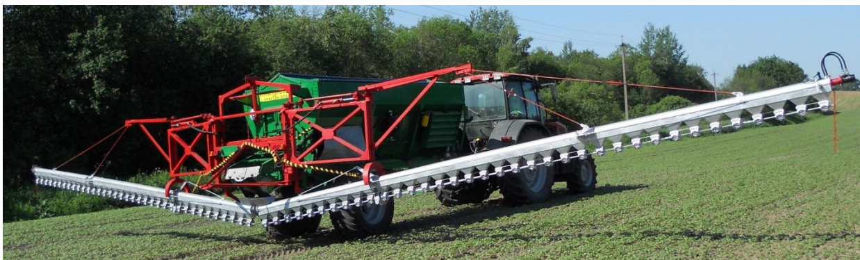
Рисунок 4. – Общий вид рассеивателя РМУ-11000 со штанговыми распределителями
