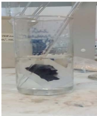
Рисунок. Мембранный реактор с сорбентом в стакане с раствором. Пакетированный в трековую мембрану сорбент – берлинская лазурь.
