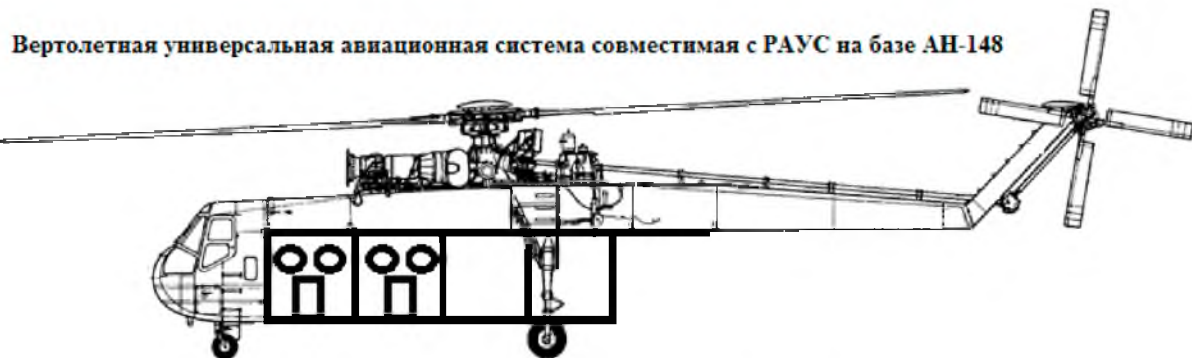
Рис. 14. Совместимость модуль-контейнера с вертолетом
