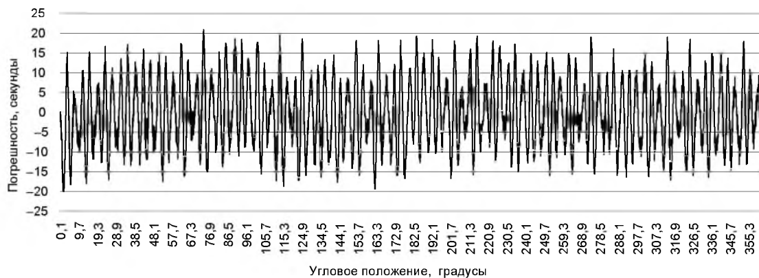
Рис. 7. Разница показаний эталонного датчика и преобразователя угол-код
