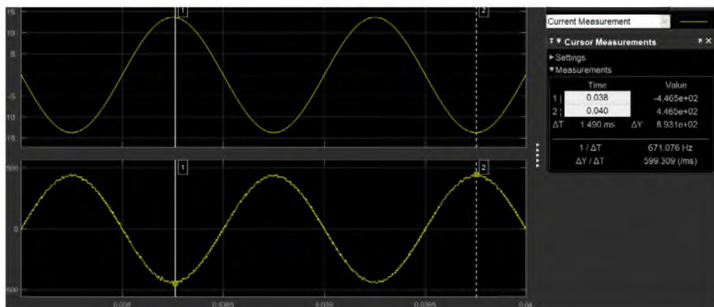
Рис. 10. Установившиеся значения сетевых напряжения и тока СИН в РСАР ( f=1000 Гц)
