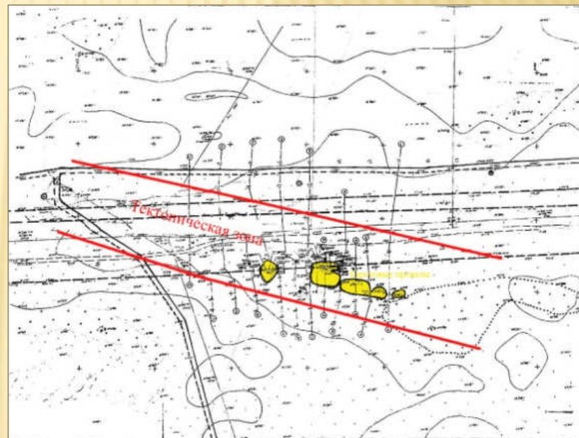
Ее использование позволило определить причины активизации процессов карстообразования, связанные с тектоникой, связанной с ней повышенной геодинамической активностью и скважинным водозабором
