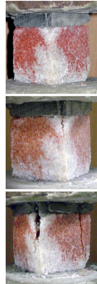
Характер разрушения образцов
