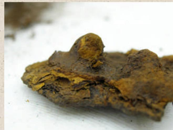
Образец разрушенного графитизированного чугуна
