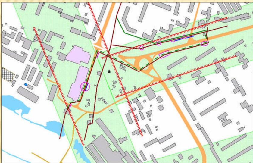
С помощью электрометрии были уточнены границы тектонических нарушений в районе аварии, определена сущность процесса формирования карста
