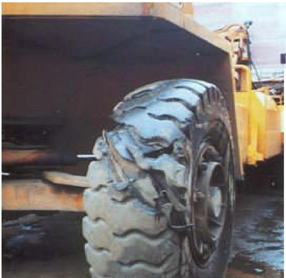
Рис.4 Колесо погрузчика VALMET находится в эксплуатации, несмотря на механические повреждения
