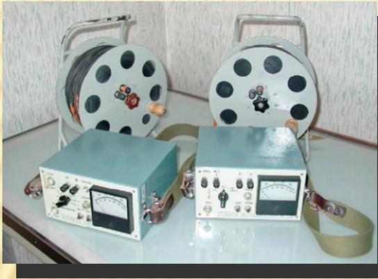
Область применения – зондирование массива горных пород до глубины 70-100 метров с целью изучения тектонического строения массива горных пород, расчленения глубинного строения по прочностным показателям, обводненности и т.п., поиск подземных вод
