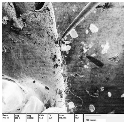
Рисунок 1. Нанозахват работает с сенсилью –волоском на ножке комара
