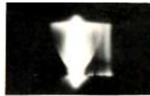
Рис.6. Фотографии кистевого разряда, показывающие движение кисти в промежутке
