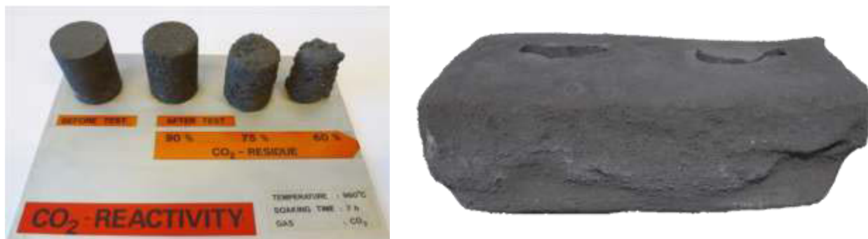
Рис. 3. Опытный образец до и после испытаний реакционной способности в \text{CO}_2 ; анод со следами сильного воздействия \text{CO}_2
