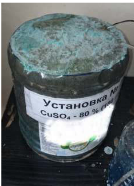
Рис. 1. Установка № 7. Раствор \text{CuSO}_4 80 % (160 г/л). Песок -0,5+0,2
