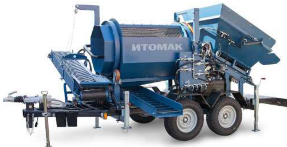
Рис. 4. Мобильный обогатительный комплекс «МОК-5»
