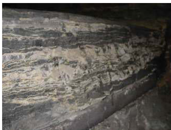
Рис. 2. Катодный блок со следами горизонтального растрескивания и попадания металла внутрь. Вышел из строя примерно через 180 дней.
