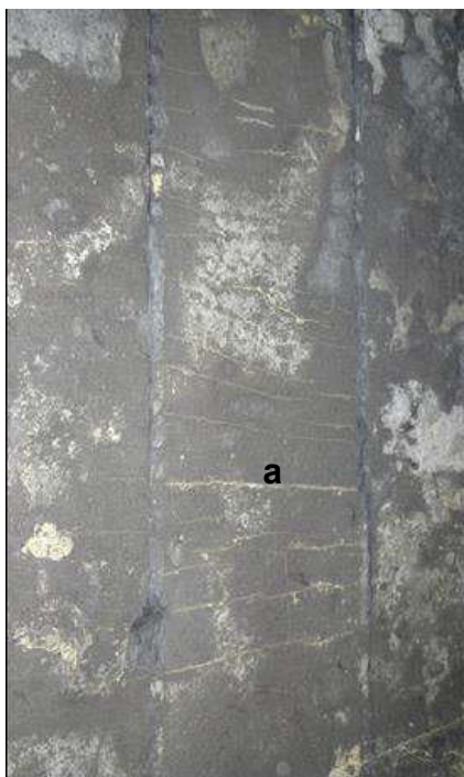
Рис. 5. Чрезмерное растрескивание (а) катодных блоков, ведущее к образованию воронок (b)
