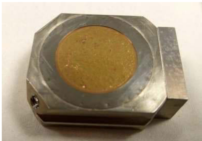
Рис. 1. Прободержатель МСВИ с зафиксированным образцом Pb-Zn руды, покрытым золотом
