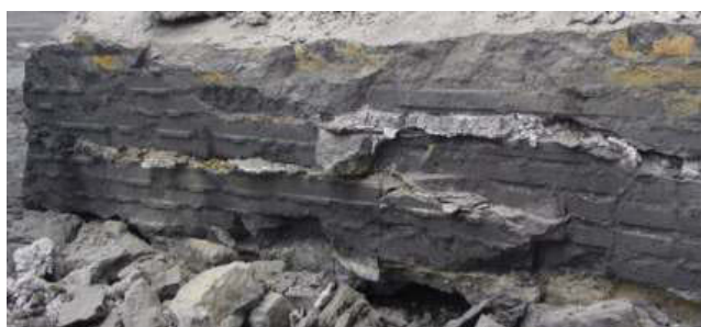
Рис. 5. Инфильтрация металла в горизонтальные трещины отечественных катодов
