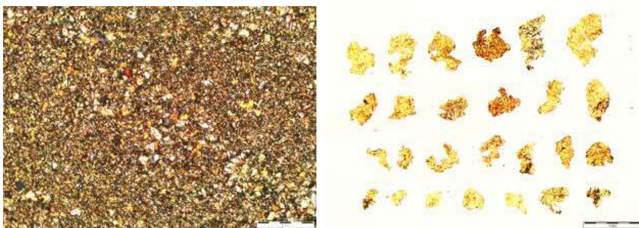
Рис. 3. Форма и размер частиц золота в концентрате флэш-флотации песков гидроциклонов ЗИФ «Вернинская» min размеры – единицы микрон, max – 300x500мкм
