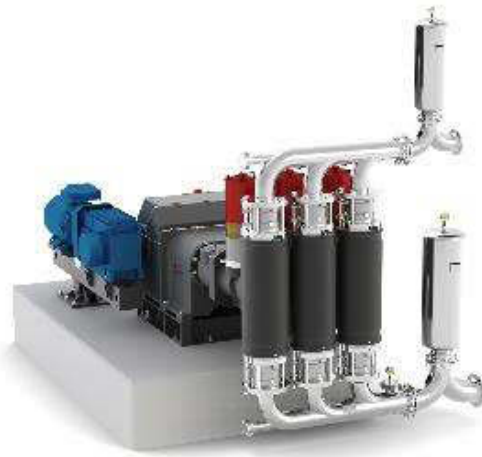
Рис. 4. Трехцилиндровая конфигурация двухшлангового мембранного насоса
