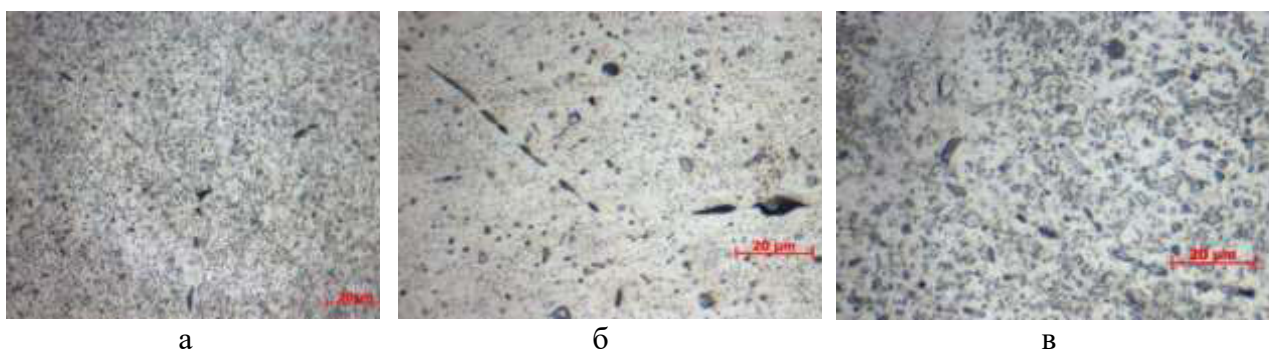
Рис. 2. Структура сплавов системы Al-Mg-Zn: а) Al-6,0 % Mg- 2,0 % Zn; б) Al-5,5 % Mg-2,5 % Zn; в) Al – 5,0 % Mg- 3,0 % Zn. \times 1000
