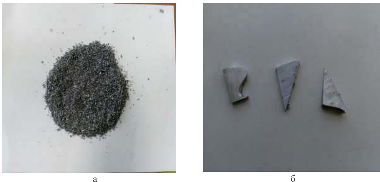
Рис. 3. Внешний вид: стружки из А85 (а), и металла А85 (в кусках)
