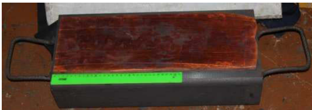
Рис. 2. Биметаллический образец сталь-медь, полученный по режиму 2
