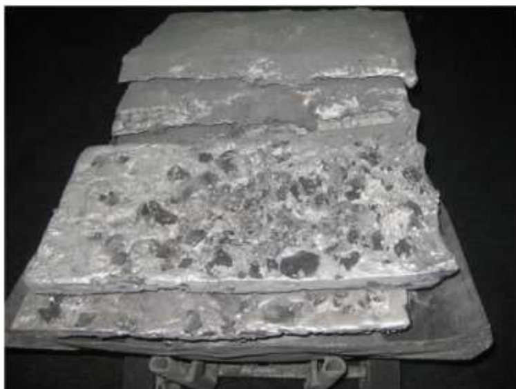
Рис. 1. Ремонтная масса в виде плит
