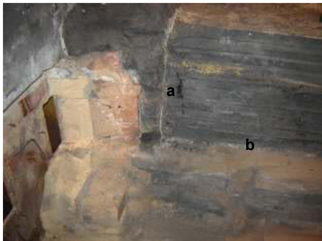
Рис. 10. Протечка металла (a) в районе периметра шва. Металл вытек из блюмса и попал под катодные блоки (b)
