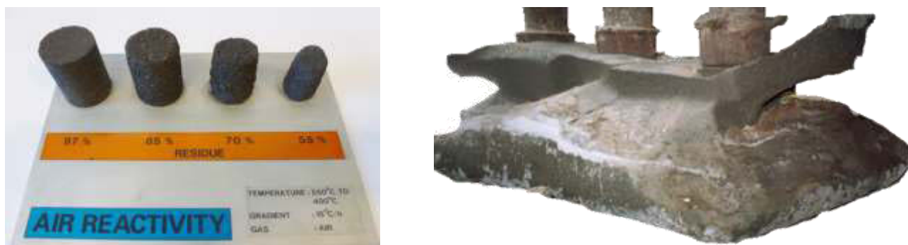
Рис. 4. Опытный образец до и после испытаний реакции на воздухе; анод со следами сильного горения в воздухе
