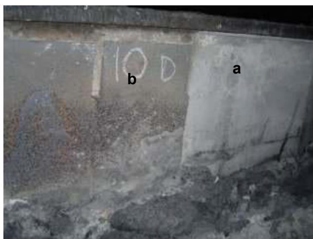
Рис. 9. Параллельный тест SiC в течение 400 дней. Кирпич с нитридной связкой (a) невредим, «запатентованная» связующая система (b) разрушилась.
