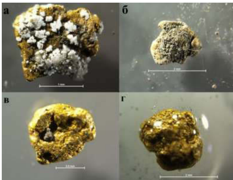
Рис. 2. Золотоносные фазы: а – розенит после естественного испарения воды; б – железистая пленка после стадии нагревания; в – частицы сульфида в западинах золотины после стадии заморозки; г – золотина в капле воды
