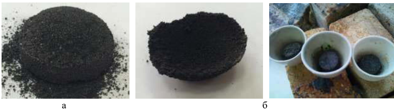
Рис.5. Образцы, изготовленные из ХНПМ: а – без добавки \text{Li}_2\text{CO}_3 ; б – с добавкой \text{Li}_2\text{CO}_3
