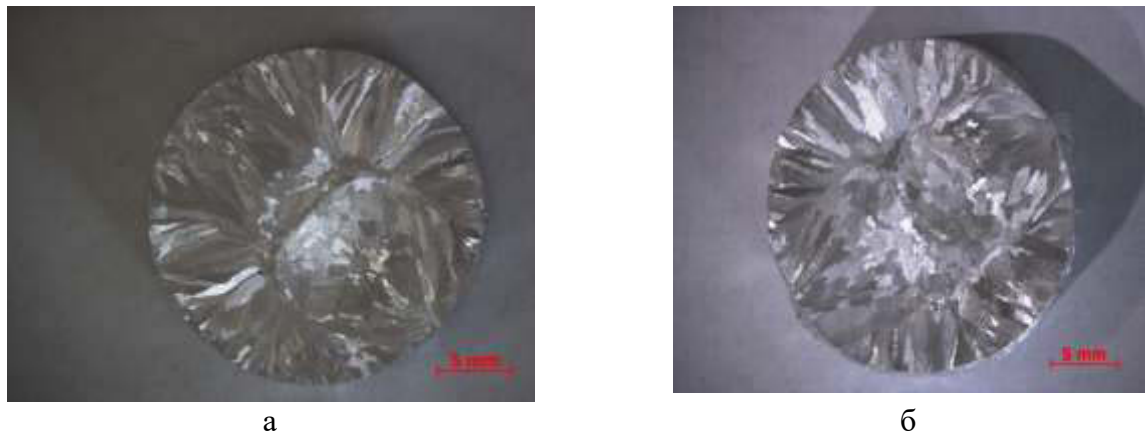
а б Рис. 3. Образцы 5 и 6 из А85 модифицированные стружкой АМг6 : А – до МА (образец 5), б – после МА (образец 6). Метод введения модификатора – холодное брикетирование
