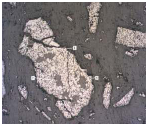
Рис. 4. Общий вид пробы настыли аптейка: 1 – треворит, 2 – алюмосиликат кальция и железа, 3 – силикат. Увеличение 50*
