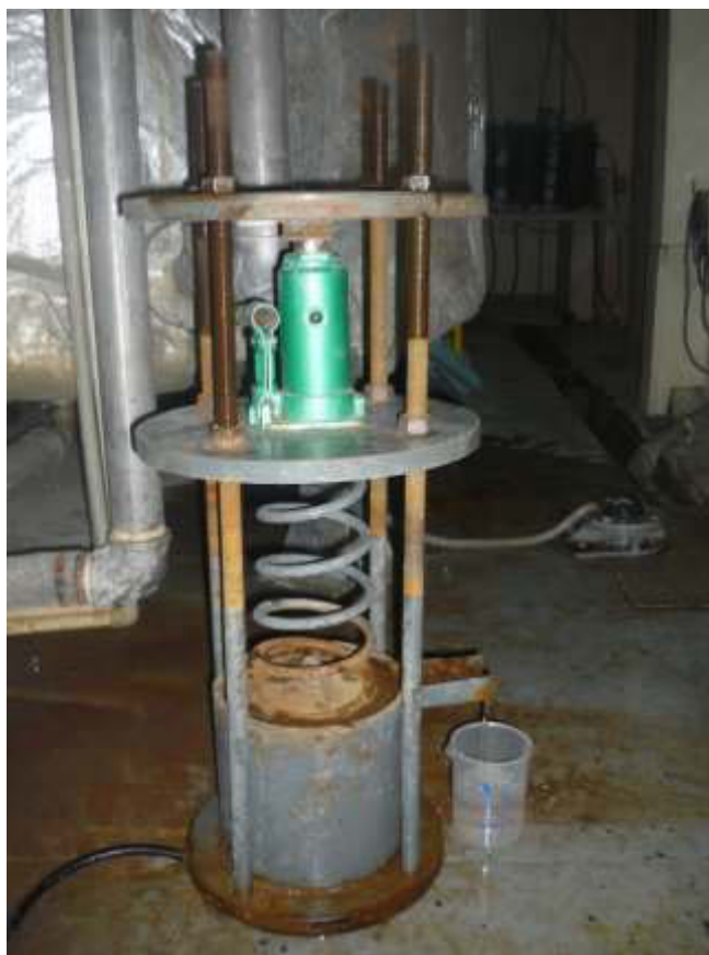
Рис. 4. Лабораторная установка под нагрузкой, имитирующей давление, создаваемой кучей при различной высоте отсыпаемого штабеля
