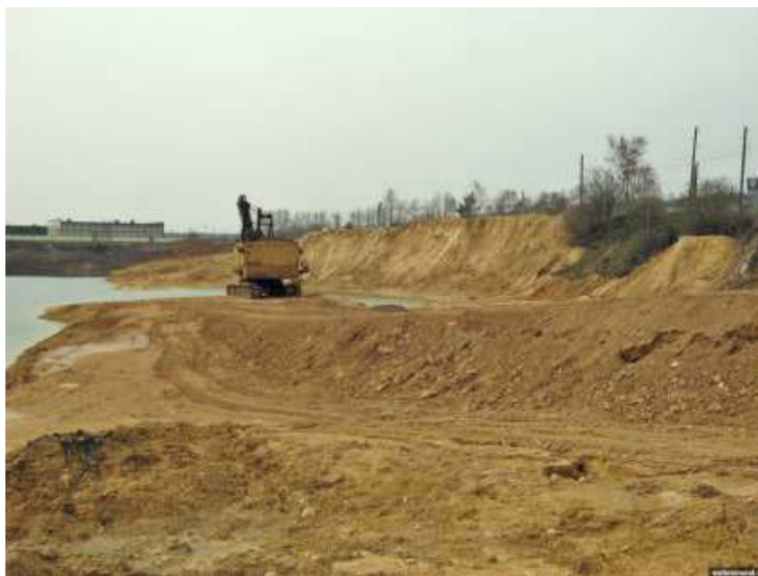
Рис.1. Добыча доломита Щёлковского месторождения в Щёлковском районе Московской области с запасами 11,4 млн т.
