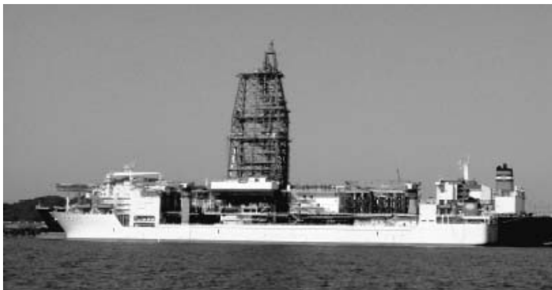
Судно “Чикиу” на верфи Мицубиши Хэви Индастриз Лтд. в Нагасаки после монтажа деррика буровой установки, сент. 2003 г. (по: [Austin, 2004]).
