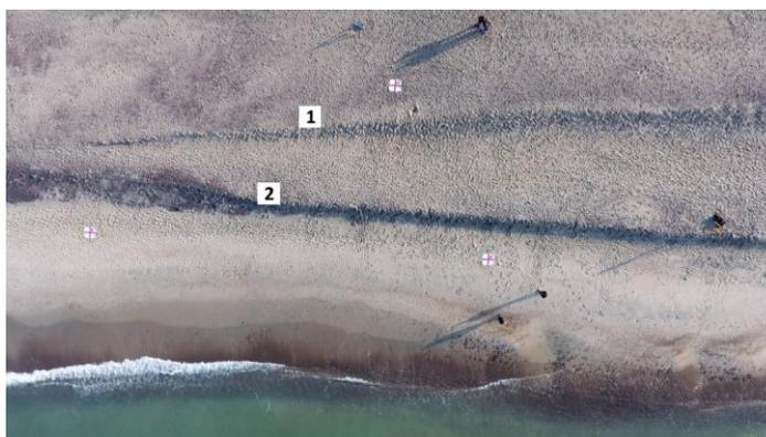
Рисунок 5 – Пример. Две генерации не штормовых уступов размыва пляжа по аэроортофотографии на уч. 14 км.
