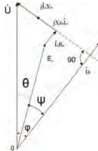
Рисунок 1. – Векторная диаграмма одной фазы обмотки статора:
