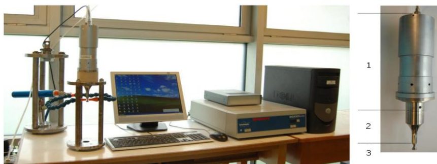
Рис. 2. Общий вид установки и её детали: (1) пьезоэлемент, работающий на кручение, (2) волновод и (3) образец
