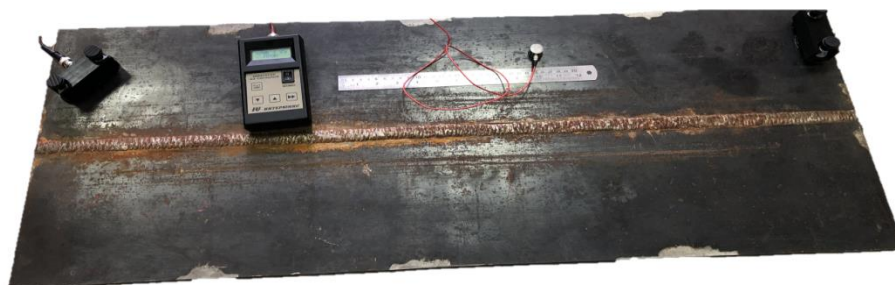
Рис. 1 Схема построения линейной локации акустических сигналов на стальной пластине
