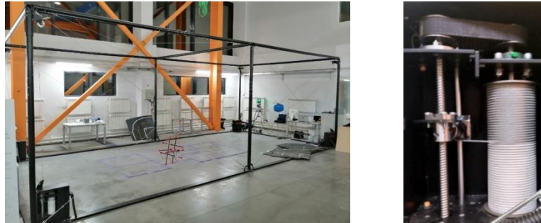
Рис.1. Прототип тросового робота (слева) и механизм намотки (справа)
