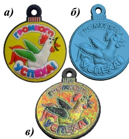
Рис. 5. Изделие СП-2: а – исходное изделие; б – stl-модель; в – нанесение цветной текстуры
