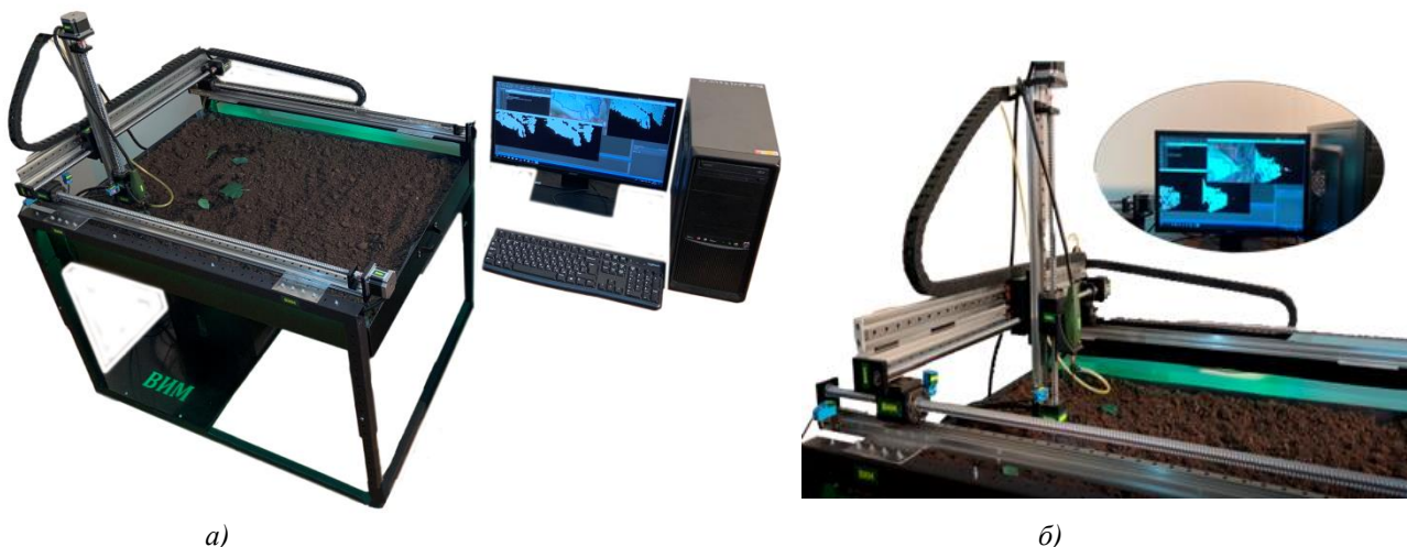
а) б) Рис. 4. Разработанный в ходе исследовательской работы автономный роботизированный комплекс контроля сорной растительности: а) полная установка; б) рабочий узел в момент обработки растительности
