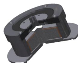
Рис.2. Демпфер на основе МРЭ в разрезе (твердотельная модель)
