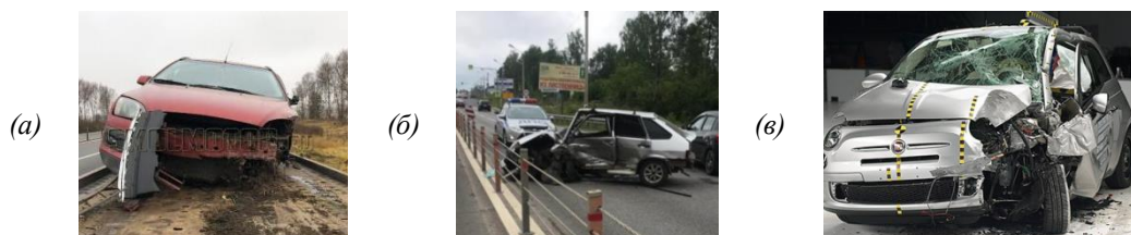
Рис. 5. Автомобиль после удара: (а) тросовое ограждение, удар не в лонжерон, (б) тросовое ограждение удар в лонжерон, (в) краш-тест с перекрытием 25%
