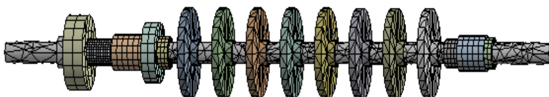
Рис.4. Конечно-элементная модель свободного ротора насоса уменьшенной размерности (с инерционно-эквивалентными дисками, всего 4105 элементов)
