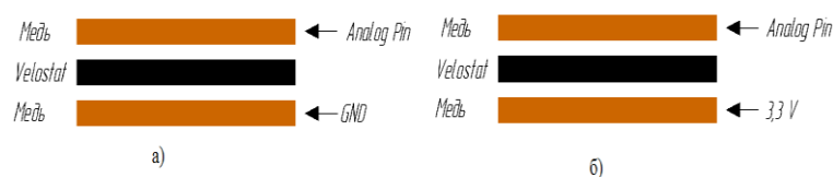
Рис.1. Структурная схема ЛИС: а) подключение с резистором, б) подключение без резистора
