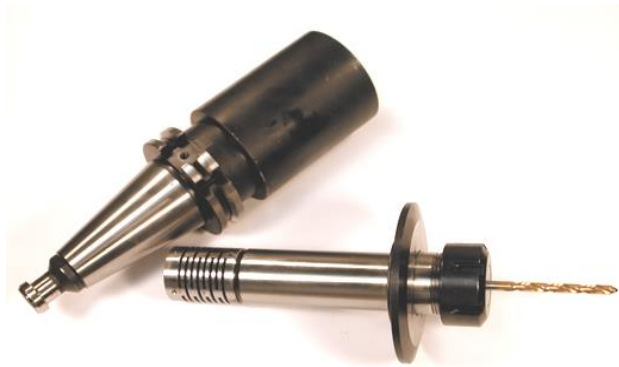
Рис.1. Фотография вибропатрона со встроенным упругим элементом
