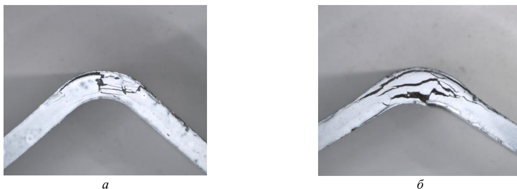
Рис. 3. Характерные виды разрушения образцов слоистого углепластика (а) и слоистого углепластика с поперечной прошивкой (б)
