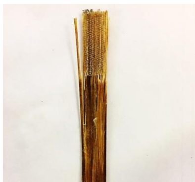
Рис.1. Образец из углепластика после растяжения. Разрыв в захватах
