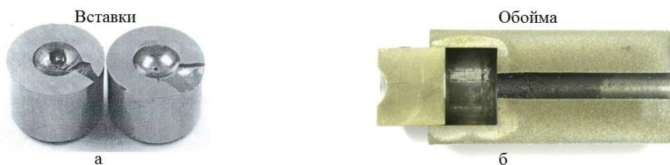
Рис. 3. Инструмент для высадки заклепки а) вставки, б) пуансон в разрезе
