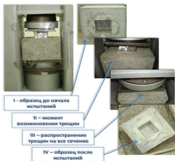
Рис.1. Стадии испытаний образцов оголовков типа «колокол», выполненных из фибробетона
