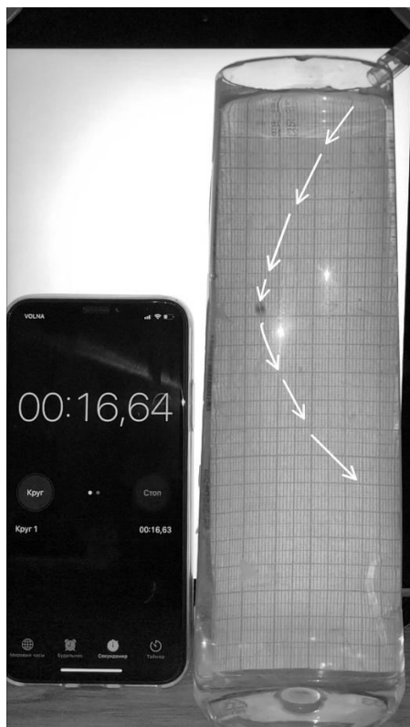
Рис. 2. Эффект Магнуса в жидкости с металлическим шаром
