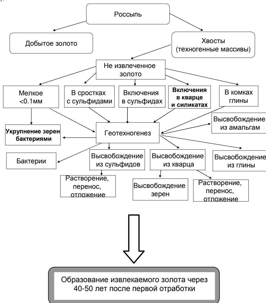
Рис. 3. Схема преобразований золота в техногенной россыпи.
