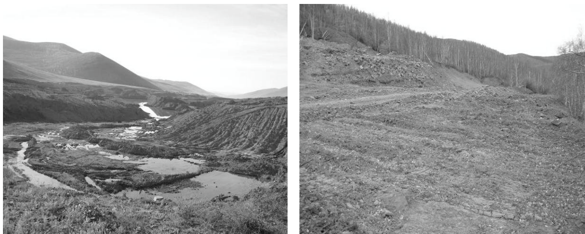
Рис. 3. Котлован выемки песков в днище и склон со снятым почвенно-растительным покровом на буровом профиле (участок Евграфовский) в вершине п. Дунда-Хонгорун.
