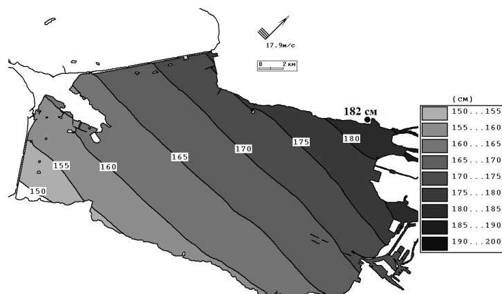
Рис. 2. Изолинии уровня (см БС) в Невской губе при юго-западном ветре 17,9 м/с и расходе Невы 4700 м 3 /с в момент подъема уровня у Горного института до 190 см БС. КЗС закрыт при подъеме уровня у судопропускного сооружения С-1 до 1 м БС. Модель NBM6
