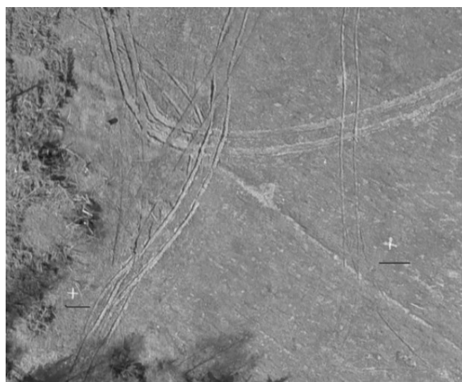
Рис. 5. Пример марок для привязки ортофотоплана
