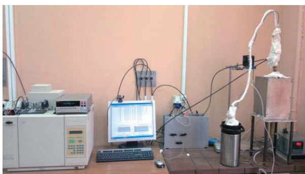
Рисунок 1 – Установка для испытания трубчатых керамических мембран в условиях одновременной реализации процессов расщепления воды и парциального окисления метана
