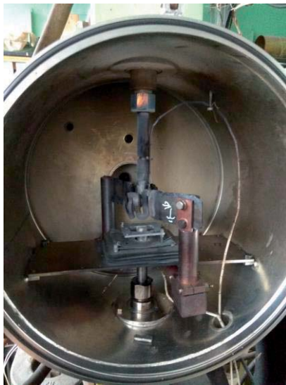
Рисунок 1. Оригинальная вакуумная камера с нагревателем, позволяющая производить измерения до 1300°C
