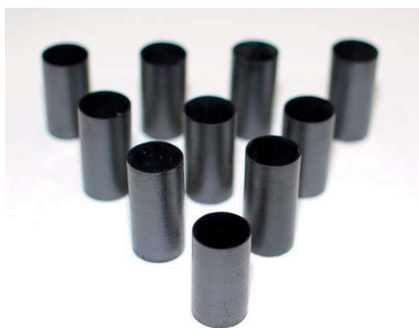
Рис. 3. Внешний вид несущих твердых электролитов на основе LaScO_3 для трубчатых протонно-керамических топливных элементов
