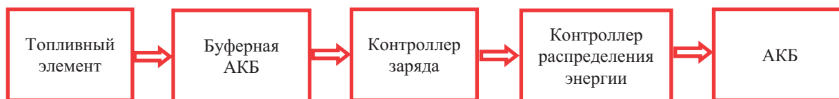
Рисунок 3 – Схема интеграции топливного элемента в состав энергоустановки
