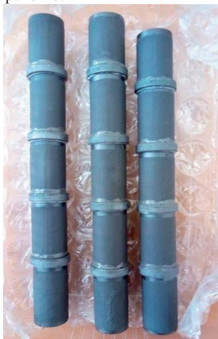
Рис. Батареи ПКТЭ на несущем протонпроводящем электролите на основе скандата лантана и характеристика такого элемента в увлажненном метане
