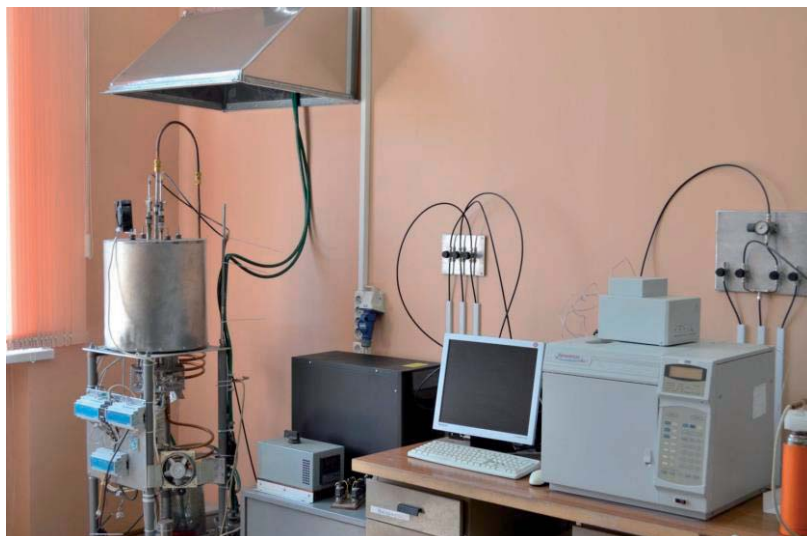
Рисунок 3 – реактор с 10 мембранными элементами и стенд для его испытаний в условиях одновременного получения водорода расщеплением воды и синтез газа парциальным окислением метана
