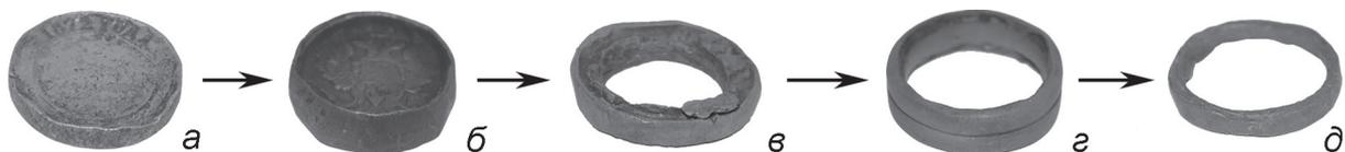
Рис. 1. Процесс изготовления колец из медных монет
