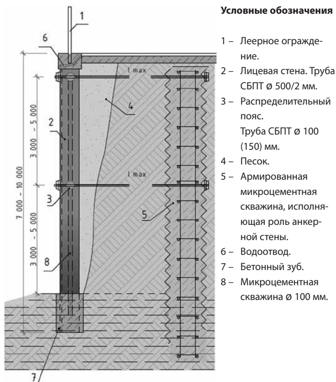
Рис. 4. Прибрежный этап. Принципиальная схема вертикальной проекции лицевой стенки из СБПТ-труб устройством распределительных поясов, анкерных тяг и верхним строением береговой линии
