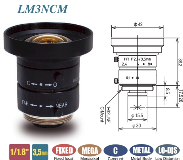
Рис.6. Общий вид объектива Kowa LM3NCM и его геометрические размеры
