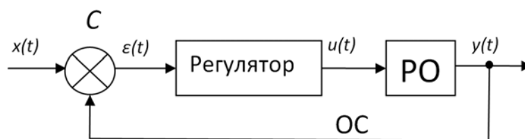
Рис. 3 Блок- схема САР Ползунова – Уатта ОС – обратная связь
