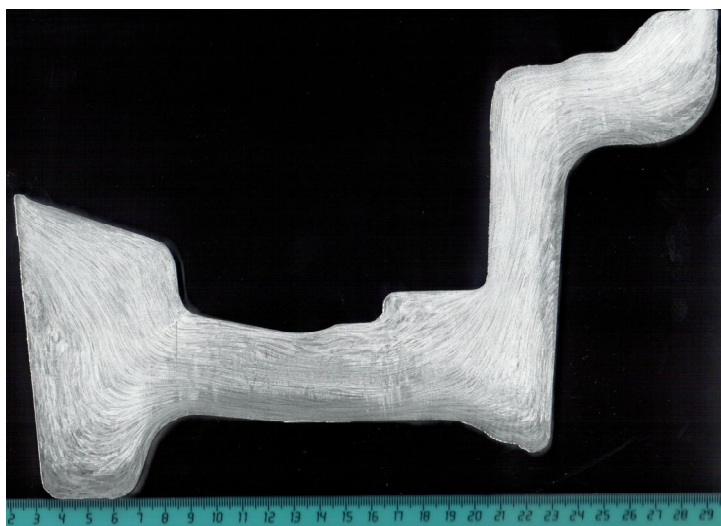
Рис. 1 – Макроструктура опытно-промышленных точных штамповок из сплава В-1469, полученных методом изотермической деформации
