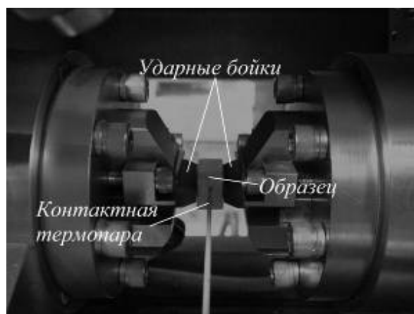
Рис. 1 – Образец перед испытанием в рабочей камере модуля Hydrowedge II комплекса Gleeble System 3800
