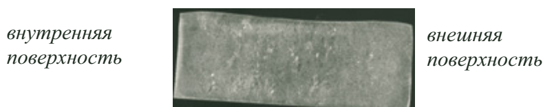
Рис. 1. Макроструктура темплета после экспандирования в продольном сечении (без увеличения)
