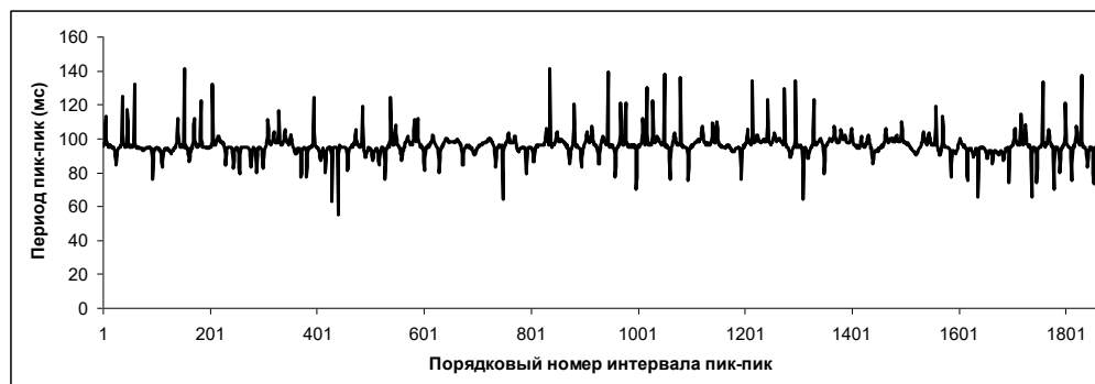
Рисунок 3. Кривая “пик-пик” (максимумы) для сигнала ЭЭГ (О1, фотостимуляция 14 Гц) отфильтрованного с использованием преобразования Фурье в частотном диапазоне 10-11 Гц.
