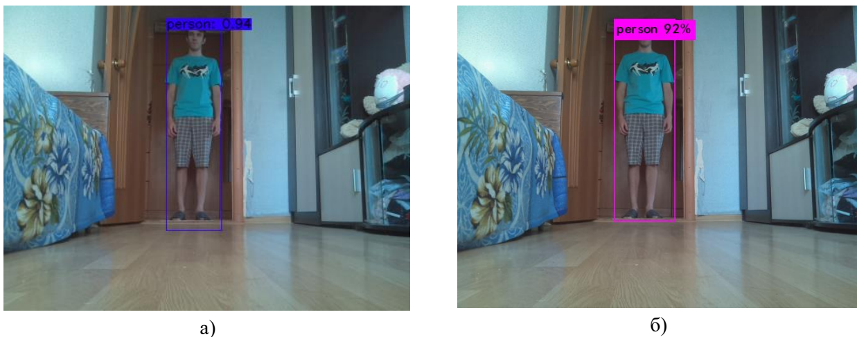
Рис. 4. Примеры детектирования объектов сетью: а) MobileNETSSDv2; б) YOLOv3-tiny
