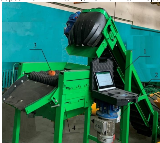
Рис. 1. Общий вид лабораторной установки по определению места и уровня повреждений корнеплодов и лука:
