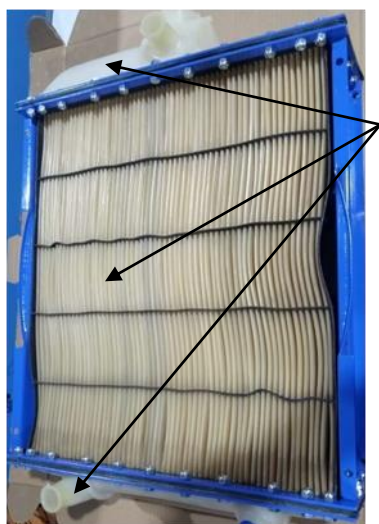
Рис. 1. Тракторный радиатор МТЗ-80 системы охлаждения двигателя с полиуретановой сердцевиной
