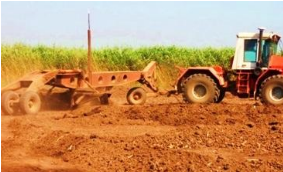
Рис.1. Клин-планировщик при работе на прямолинейных участках чека (а) и в местах разворотов машины (б)
