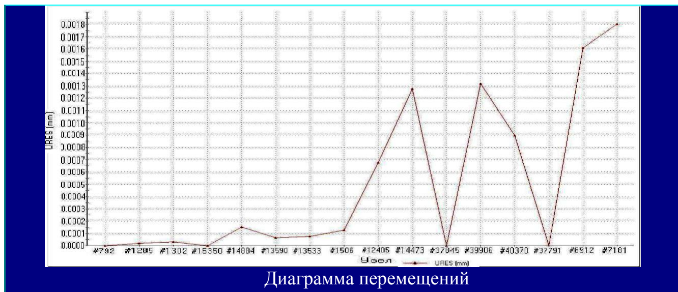
Рис. 1. Результаты анализа шпинделя на жесткость
