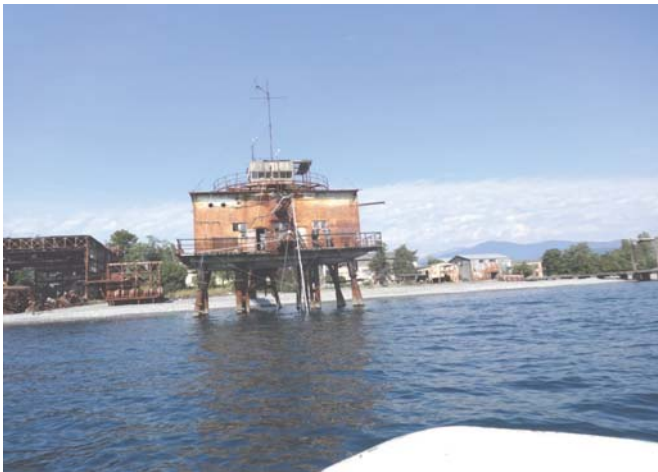
Рис.1. Эстакада ГИАНА, с которой проводились многосуточные измерения течений и вертикального распределения температуры и скорости звука.
