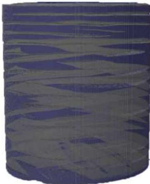
Рис. 2 – Рентгеновская компьютерная томография композитов \text{Ti}_3\text{Al}(\text{Si})\text{C}_2 с упрочняющими волокнами SiC
