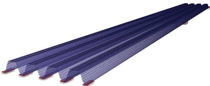
Рис.1 Расчетная схема для конечно-элементного расчета
