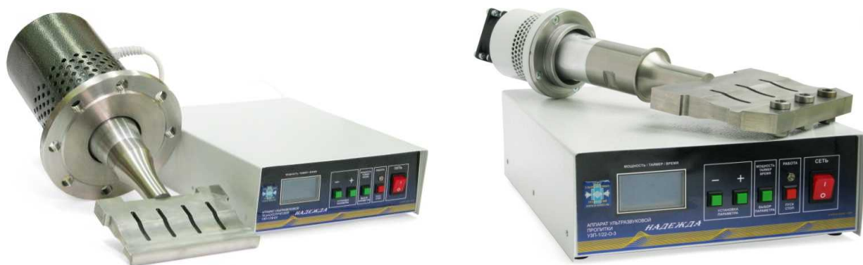
Рис. 3. Ультразвуковое оборудование для интенсификации процессов на границе раздела двух фаз
