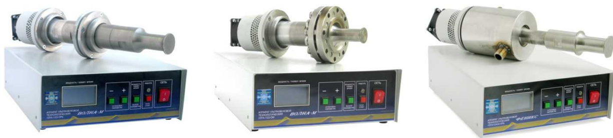
Рис. 2. Ультразвуковое оборудование кавитационной обработки жидких сред
