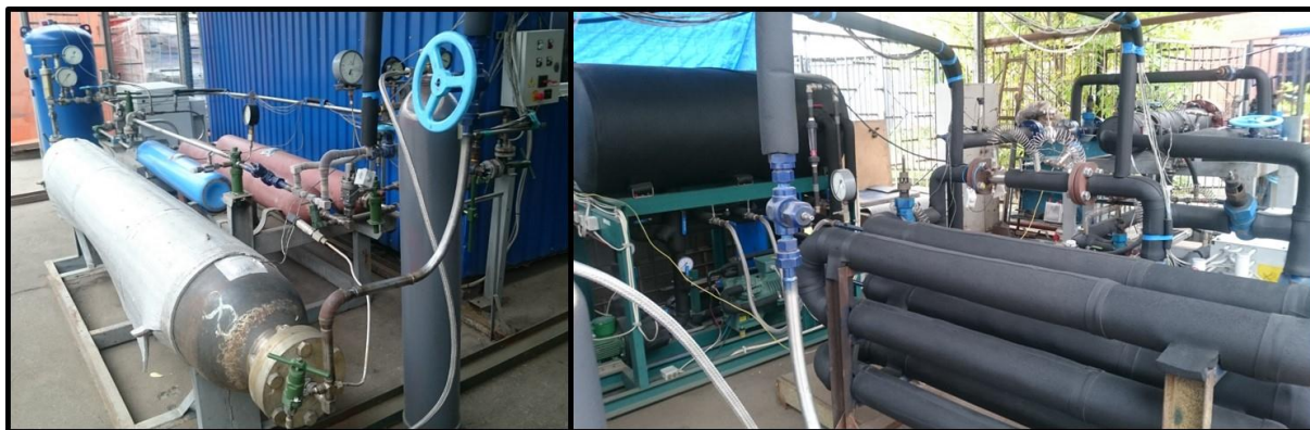
Рис. 1 – Фотографии экспериментального стенда для исследования процессов заправки и выдачи природного газа из адсорбционного аккумулятора
