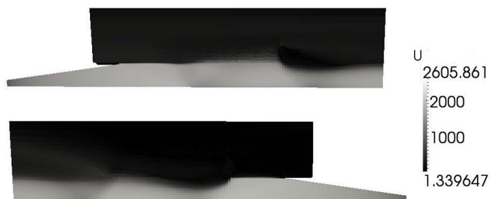
Рис. 2. Распределение скорости газовой фазы
