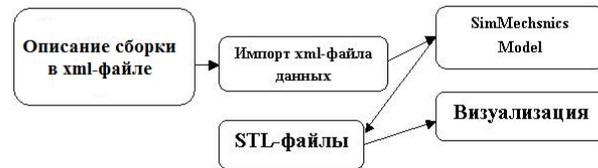
Рис. 1. Этапы трансляции конструкторской 3D-модели в имитационную модель MatLab
