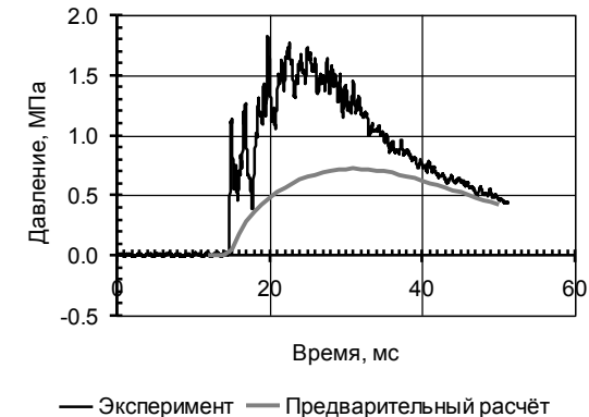
Рис. 2. Экспериментальная и предварительная расчетная зависимости давления в рабочей полости ПС
