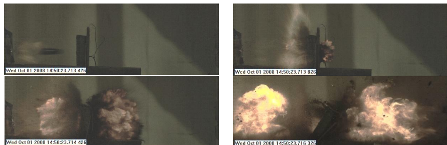
Рис. 1. Кинограмма процесса пробития брони средней твердости АК-25 толщиной 40мм снарядом калибра 30 мм, снаряженного МФК.
