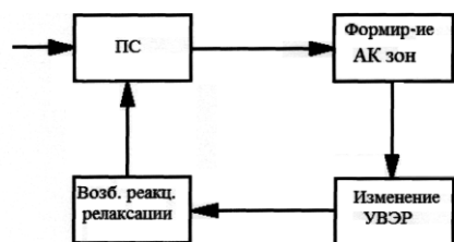
Рис.3 Стадии энергоподпитки внутрикамерной ВЧ-неустойчивости
