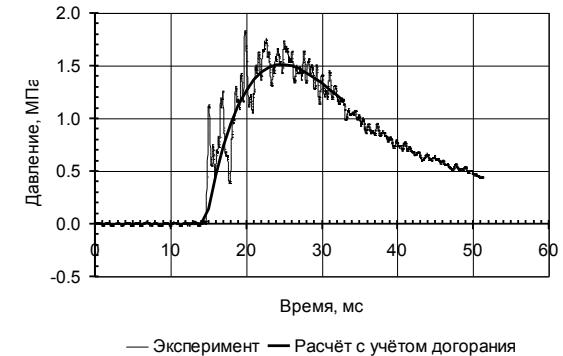
Рис. 5. Экспериментальная и расчетная зависимости давления в рабочей полости ПС от времени
