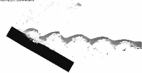
Рис. 5. 2D сечение трехмерной расчетной области взаимодействия стержня с метаемой ребристой пластиной и преградой
