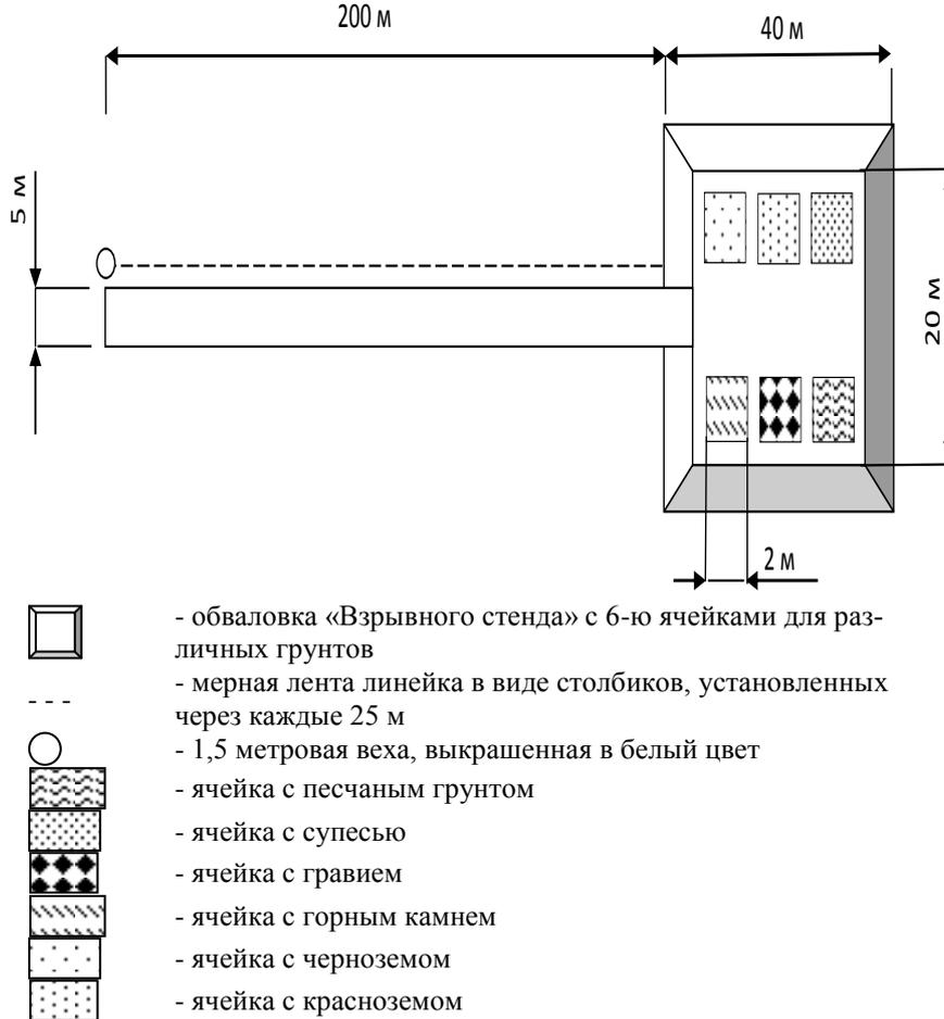
Рис. 11. Стенд «Лаборатория обезвреживания»
