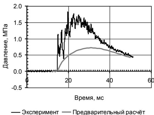
Рис. 2. Экспериментальная и первоначальная расчетная зависимости давления в рабочей полости ПС
