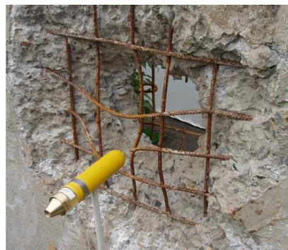
Рис. 2.2. Разрушение железобетонной плиты многоцелевым снарядом 40-мм пушки СТWS 40
