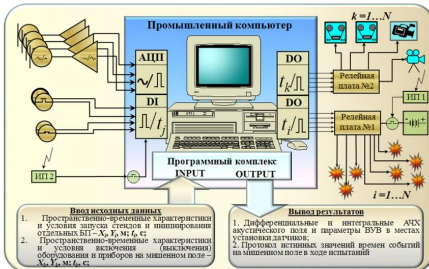
Рис. 13. Функциональная схема программно-аппаратного комплекса управления испытаниями
