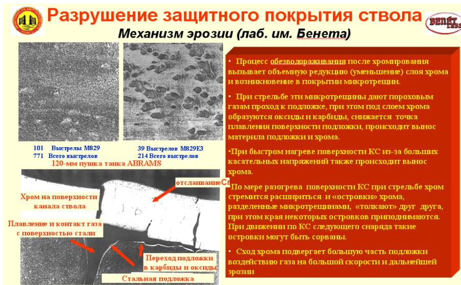
Рис. 5. Разрушение защитного покрытия ствола
