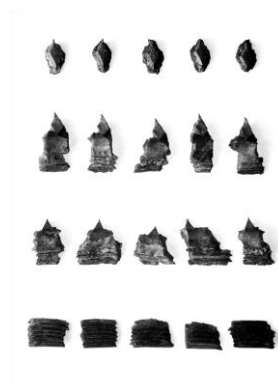
Рисунок 2 – Поражающие элементы, невошедшие в оценочную группу: 1 ряд – ПЭ весом более 6 грамм; 2 ряд – неотделившиеся ромбические ПЭ полного очертания; 3 ряд – неотделившиеся ромбические ПЭ неполного очертания; 4 ряд – ПЭ по резбке с ракетной части
