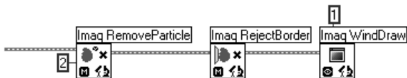
Рисунок 5 – Фрагмент алгоритма фильтрации шумов на изображении
