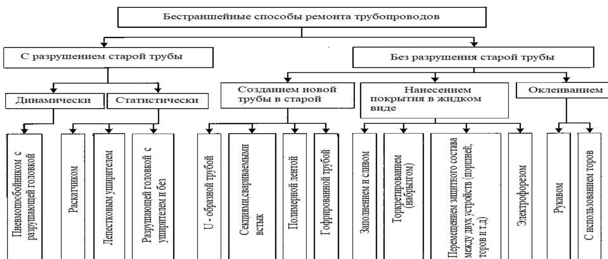
Рисунок 1 – Бестраншейные способы ремонта трубопроводов: нанесение покрытия в жидком виде перемещением защитного состава между двух устройств (поршней, торов и т. п.)
