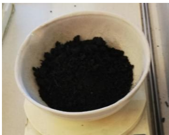
Рис. 1. Внешний вид твердого остатка пиролиза бурового шлама на нефтяной основе.
