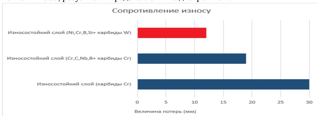
Рисунок 1 - Сопро­тивле­ние износу различных материалов
