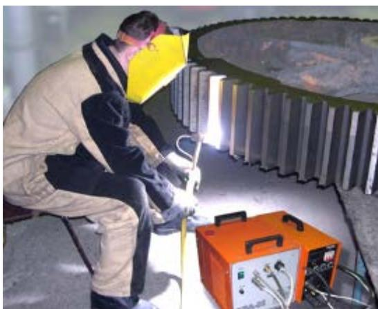
Рисунок 2 - Закалка установкой УДГЗ-200 зубьев шестерни сталеразливочного крана
