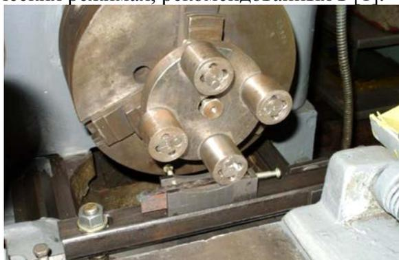
Рисунок 1 – Установка для испытаний на ударно-абразивное изнашивание
