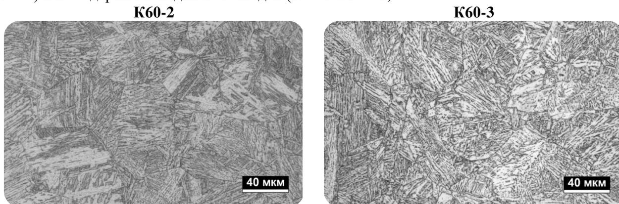
Рисунок 2 – Конечная микроструктура сталей после термоциклирования ( $w_{8/5} = 8 \text{ }^{\circ}\text{C/c}$ )
