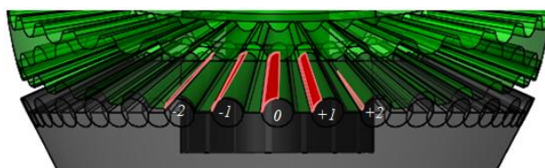
Рис .6. Интерференция колеса и шестерни
