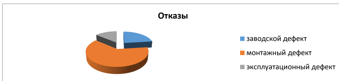
Рис. 5. Отношение количества отказов (нарушение герметичности) к общему числу обследованных вертикальных резервуаров.
