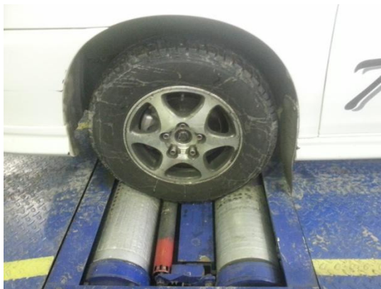
Рисунок 3. Колесо автомобиля на стенде с беговыми барабанами и роликом следящей системы
