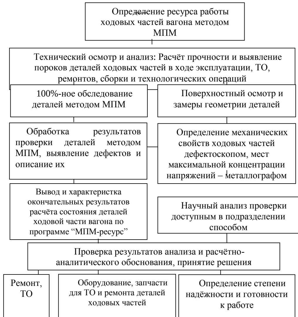
Схема1: Как продлить срок службы деталей ходовой части вагона, определив ресурс их работы с помощью метода магнитной памяти металла
