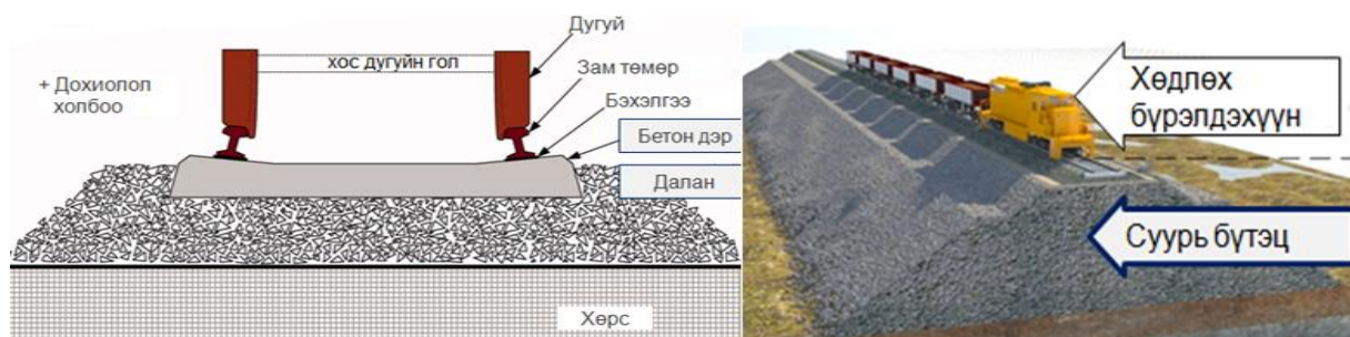
Рис.1. Строение железнодорожного пути, подвижной состав
