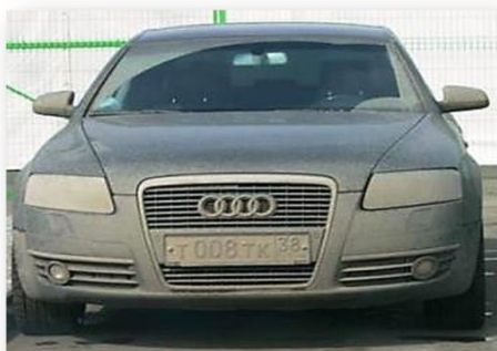
Рис.1. Внешний вид автомобиля с загрязненными внешними световыми приборами
