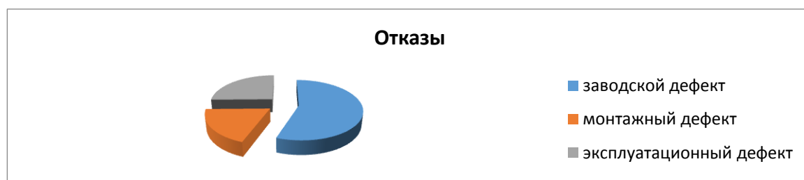
Рис. 7. Диаграмма дефектности стальных горизонтальных резервуаров в процентном соотношении
